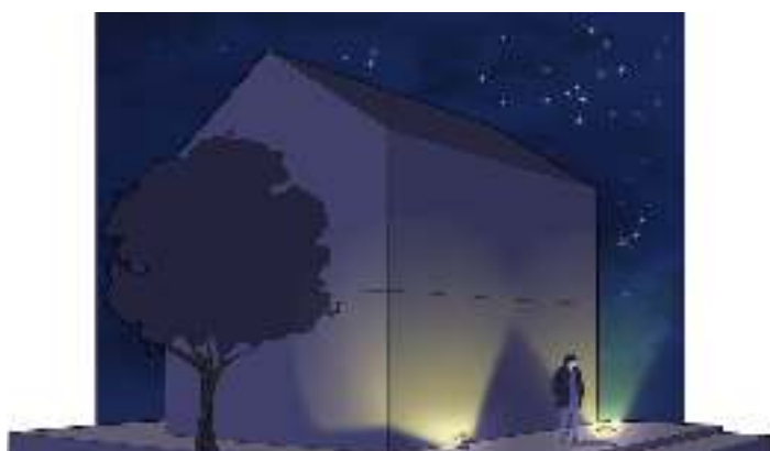
Éclairage mauvais : le flux est dirigé du bas vers le haut avec de fortes déperditions et une forte pollution lumineuse.
